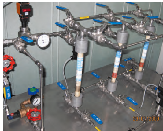
Abb. 3 Transportable Labor-Anlage zur Bestimmung des Fouling-Index.
