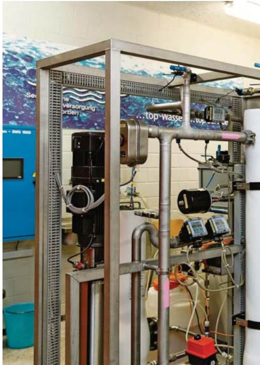
Roman Wiget neben seinem Pilotversuch. Mit der Umkehrosmose ist es möglich, die Rückstände des Pestizids
