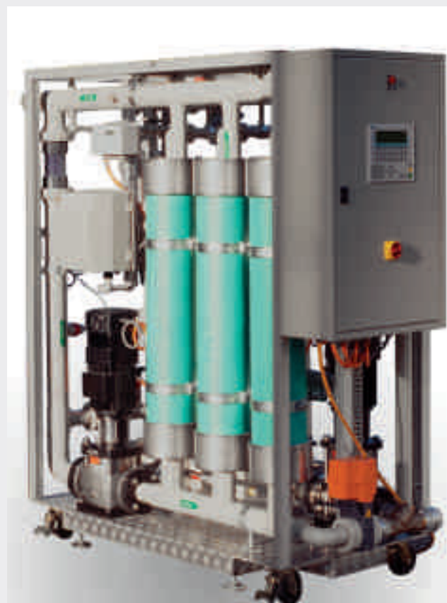
Fig. 5 Photographie du pilote d'ultrafiltration UF(F)
